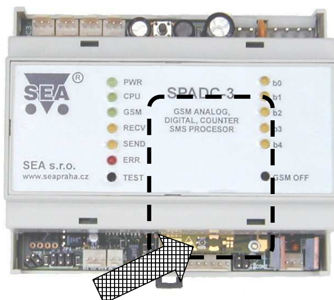
Obrázek 51 – GSM modem a pozice anténního konektoru
